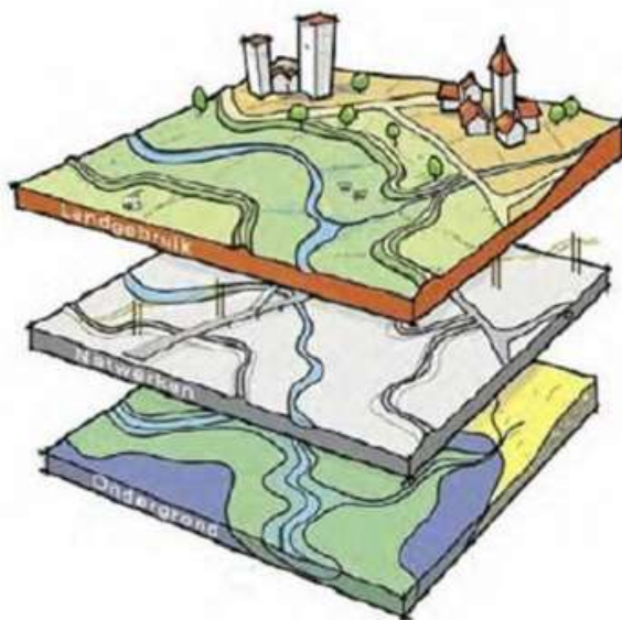
lagenbenadering: het water- en bodemsysteem als sturende laag voor de netwerken en het landgebruik (afbeelding Deltares, Bosch en Slabbers)
